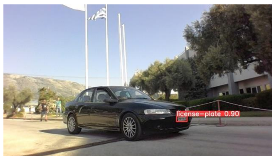
Εικόνα 14 -Αυτόματη Ανάγνωση Πινακίδας Οχήματος για έλεγχο είσοδου -Εγκαταστάσεις INTRACOM TELECOM
