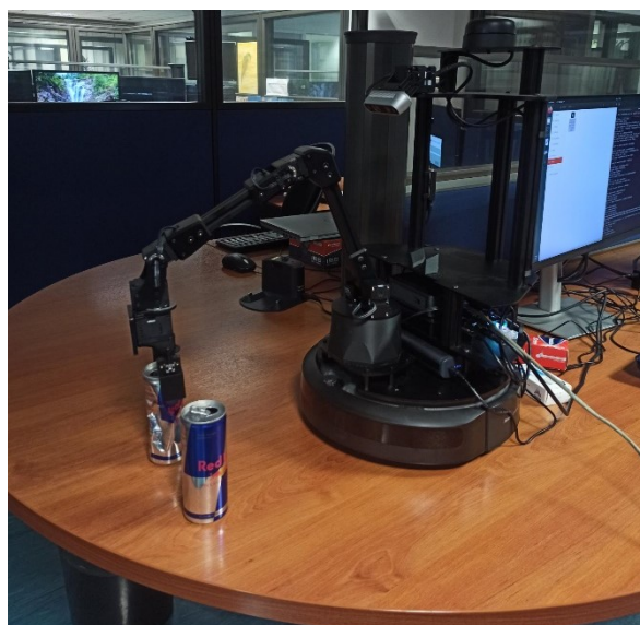
Εικόνα 5 -Έλεγχος ποιότητας με χρήση Τεχνητής Νοημοσύνης στο edge: Το ρομπότ εντοπίζει την προβληματική συσκευασία αναψυκτικού(τσαλακωμένη), την γραπώνει και την μεταφέρει στην περιοχή των προβληματικών συσκευασιών
