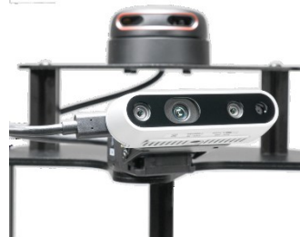
Εικόνα 10 - Τοποθετημένη η κάμερα του Ρομπότ
